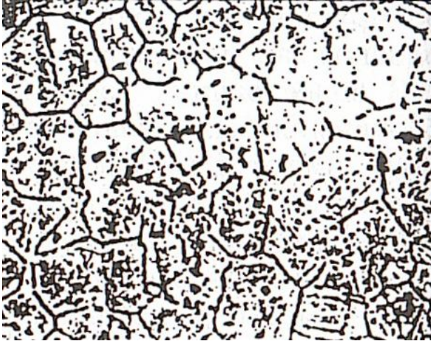
Рис. 7. Типова структура металу (x2000), легованого РЗЕ і ЛЗЕ
