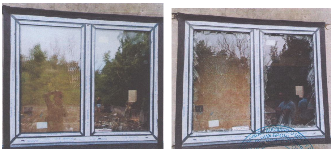
Рис. 9. Віконна конструкція зразка №S4-04_2024 до (ліворуч) та після (праворуч) випробування [7]
