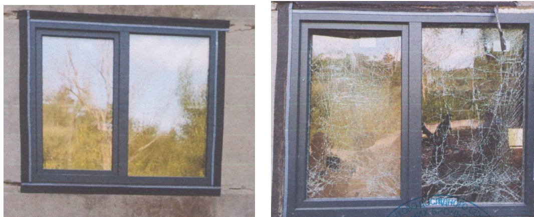
Рис. 8. Віконна конструкція зразка №S4-03_2024 до (ліворуч) та після (праворуч) випробування [7]
