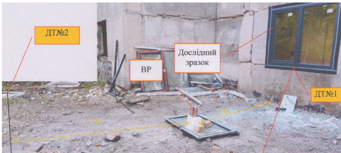
Рис. 2. Схема встановлення вимірювального обладнання [7]
