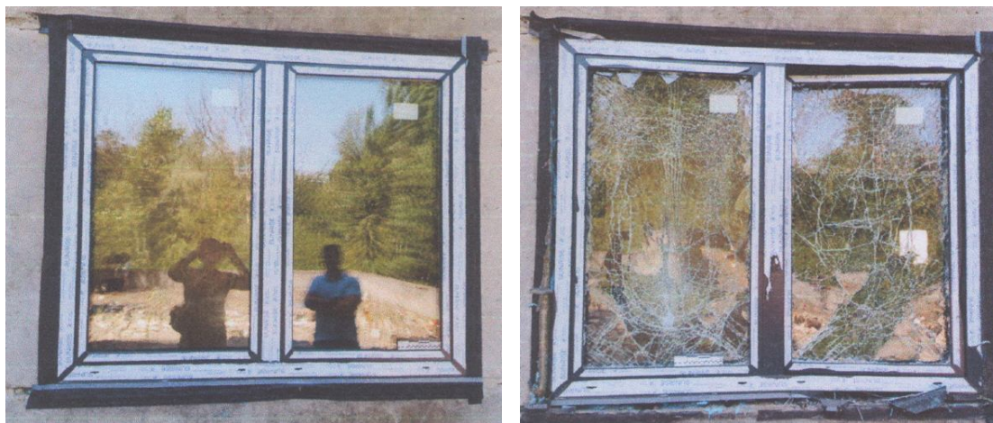
Рис. 7. Віконна конструкція зразка №S4-02_2024 до (ліворуч) та після (праворуч) випробування [7]
