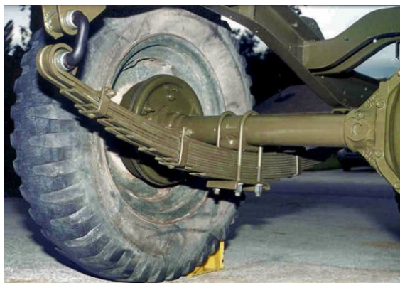
Рис. 4. Ресорна підвіска машини. Фото з відкритих джерел
