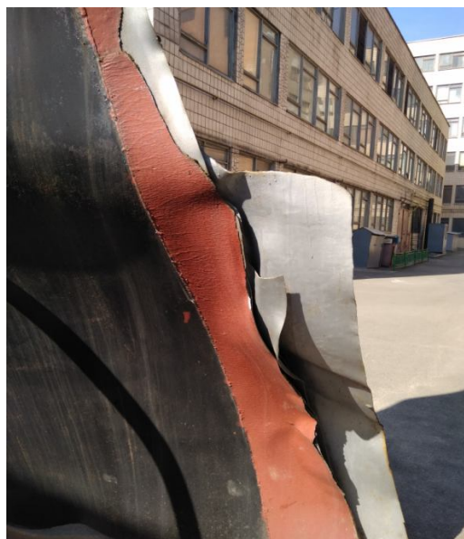
Рис. 4. Фрагменти розірваних краєв багатопрофільної труби, яка служила в якості пастки для зупинки тріщин
