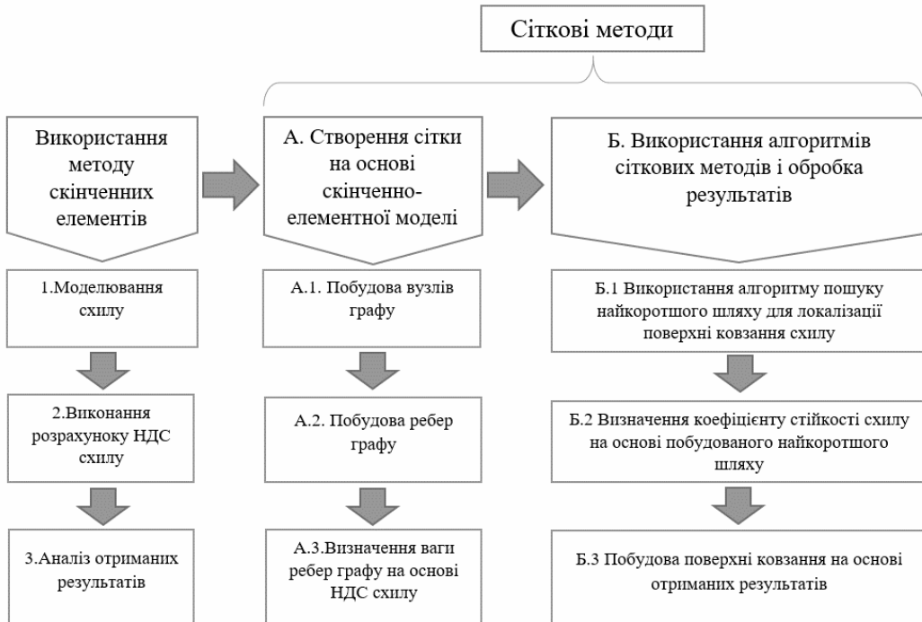
Рис. 1. Блок-схема запропонованого алгоритму оцінки стійкості схилів
