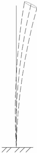
Рис. 3. Характер коливань споруди від дії фронтального вітру
